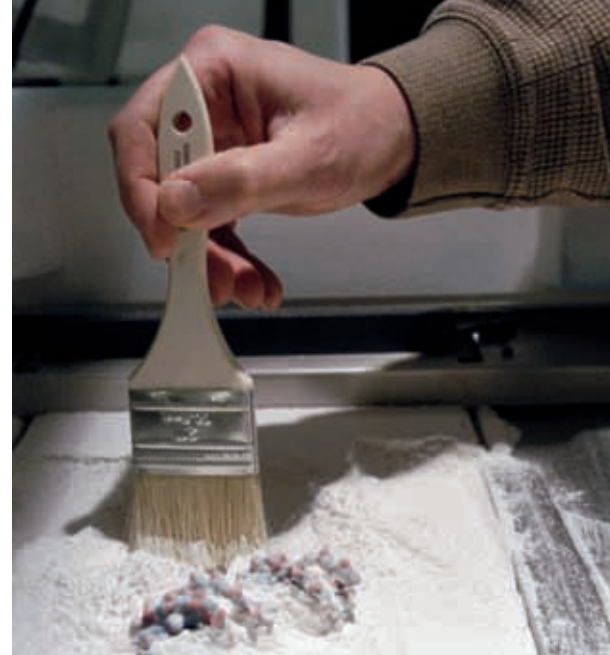
Je nach Technik, muss das „gedruckte 3D-Modell“ von der Staubschicht befreit werden.
